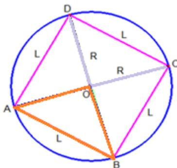
En el triángulo AOB  $AB^2 = OA^2 + OB^2$  ecu. 1, Como  $AB = L$  ecu. 2 y  $OA = OB = R$  ecu. 3, entonces sustituyendo ecu 2 y ecu. 3 en ecu. 1, tenemos:
