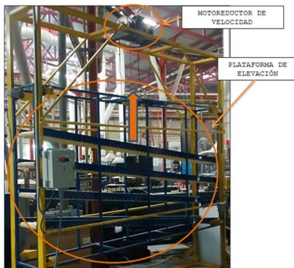
**Imagen 9:** Motorreductor elevando la plataforma de la máquina
