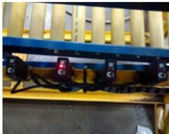
**Imagen 2:** Sensores reflectivos Autonics
