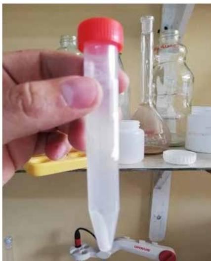
**Imagen 5.** Tubo de ensayo utilizado para hallar la capacidad emulsificante del almidón modificado.
