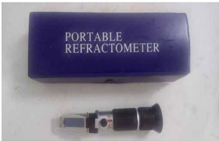
**Imagen 14.** Refractómetro, instrumento utilizado para medir SST del níspero.
