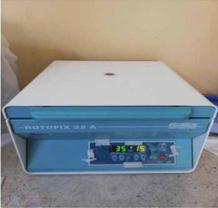
**Imagen 6.** Centrifuga utilizada en prueba de capacidad emulsificante.
