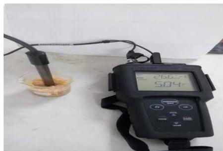
**Imagen 16.** pH-METRO, instrumento utilizado para medir el pH de los nísperos.
