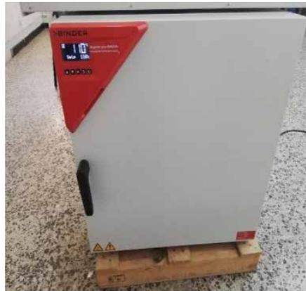
**Imagen 7.** Horno utilizado en la prueba de solubilidad.
